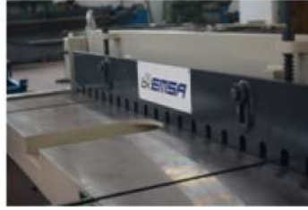
Döküm Taşlanmış tabla Cast Iron ground Table
