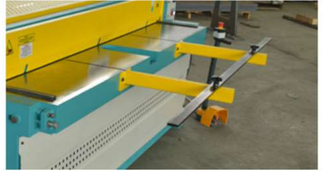
Açılı kullanılabilen Ön Dayama Kolları Frontal Support Arms in Angle position ability
