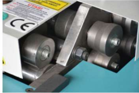
Artık Kesme Sürgü Girişi Excess Slitting Entrance of Drive Cleat
