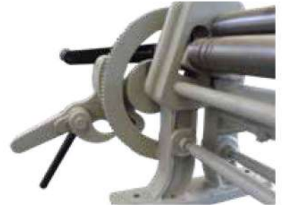
Dişli Ay Çarkı ile hızlı Arka-Top ayarlama With Geared Lock, Easy Backroll Adjustment
