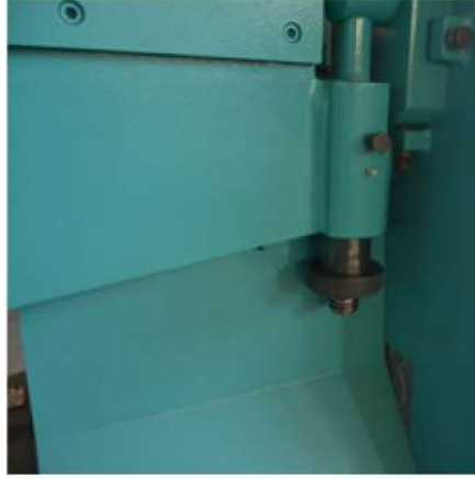
Kolayca Ayarlanan Alt Çene Açıklığı Easy Adjustable Lower Beam Position for Setback
