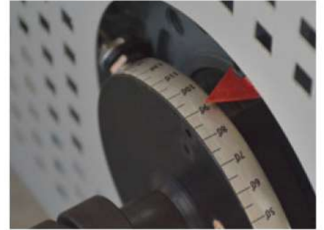
Kolay Ayarlanan Gönnye ile Bükme Açısı Ayarı Easy and Precise Angle Setup By Switch
