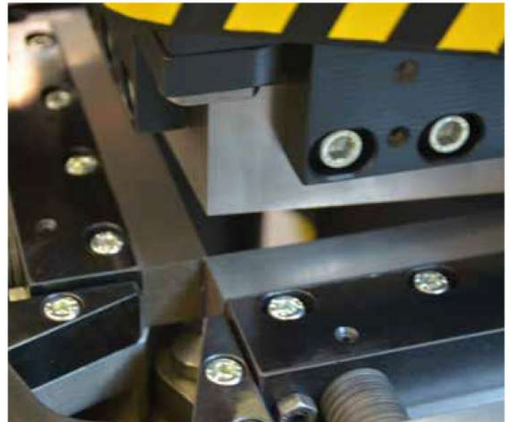
Açı Ayarlı Bıçaklar (Standart) Angle Adjustable Blades
