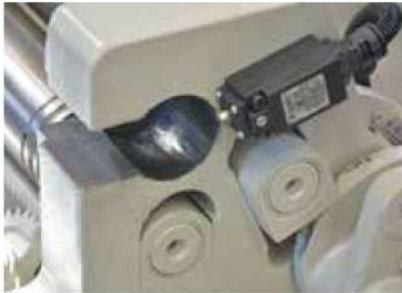
Opsiyonel Kafa Açma Sviçi Optional Drop-End Safety Switch
