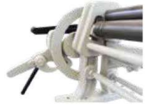
Dişli Ay Çarkı ile Hızlı Arka-Top Ayarlama With Geared Lock, Quick Back Roll Adjustment
