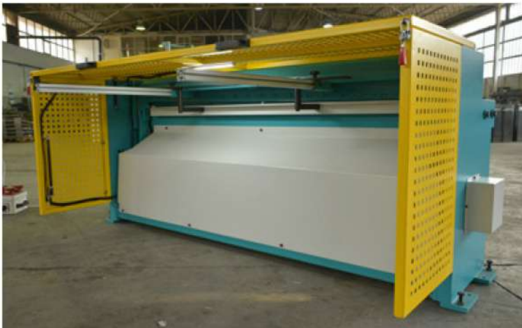
Tam Kapalı Güvenli Sac devirme bölümü Fully Closed Safe Sheet disposal area
